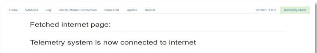
Cliccando in “Check Internet Connection” apparirà questa schermata dove è possibile verificare se il dispositivo, dopo aver impostato il corretto APN, è connesso ad Internet.
