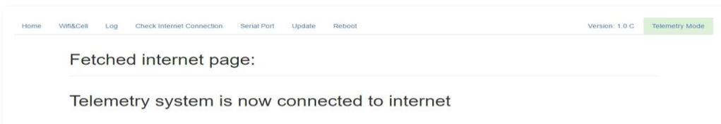
Cliccando in “Check Internet Connection” apparirà questa schermata dove è possibile verificare se il dispositivo, dopo aver impostato il corretto APN, è connesso ad Internet.
